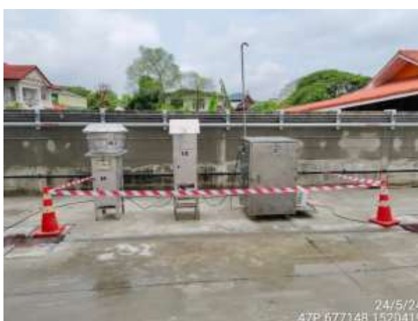
รูปที่ 2.1-38 การตรวจวัดปริมาณฝุ่นละอองรวม (TSP) และ PM-10 บริเวณพื้นที่โครงการและบ้านเลขที่ 39 ช่วงเดือนพฤษภาคม 2567
