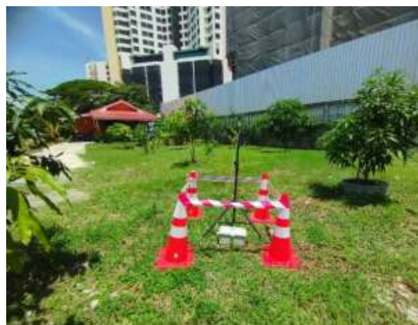
รูปที่ 2.1-35 การตรวจวัดระดับเสียง บริเวณพื้นที่โครงการและบ้านเลขที่ 39 ช่วงเดือนมีนาคม 2567
