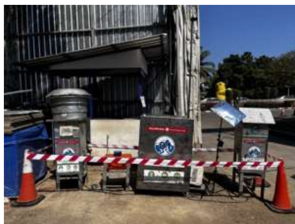
รูปที่ 2.1-26 การตรวจวัดปริมาณฝุ่นละอองรวม (TSP) และ PM10 บริเวณพื้นที่โครงการและบ้านเลขที่ 39 ช่วงเดือนมกราคม 2567
