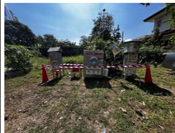
รูปที่ 2.1-26 การตรวจวัดปริมาณฝุ่นละอองรวม (TSP) และ PM10 บริเวณพื้นที่โครงการและบ้านเลขที่ 39 ช่วงเดือนมกราคม 2567
