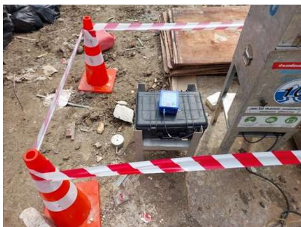
รูปที่ 2.1-31 การตรวจวัดความสั่นสะเทือน บริเวณพื้นที่โครงการและบ้านเลขที่ 39 ช่วงเดือนกุมภาพันธ์ 2567
