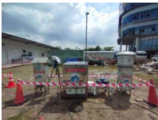
รูปที่ 2.1-34 การตรวจวัดปริมาณฝุ่นละอองรวม (TSP) และ PM-10 บริเวณพื้นที่โครงการและบ้านเลขที่ 39 ช่วงเดือนมีนาคม 2567
