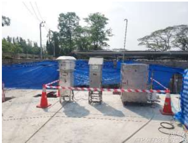
รูปที่ 2.1-36 การตรวจวัดปริมาณฝุ่นละอองรวม (TSP) และ PM-10 บริเวณพื้นที่โครงการและบ้านเลขที่ 39 ช่วงเดือนเมษายน 2567
