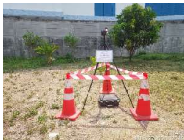
รูปที่ 2.1-37 การตรวจวัดระดับเสียง บริเวณพื้นที่โครงการและบ้านเลขที่ 39 ช่วงเดือนเมษายน 2567
