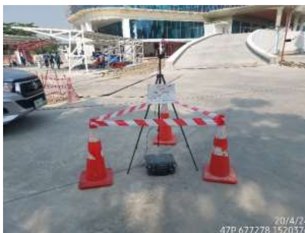
รูปที่ 2.1-37 การตรวจวัดระดับเสียง บริเวณพื้นที่โครงการและบ้านเลขที่ 39 ช่วงเดือนเมษายน 2567
