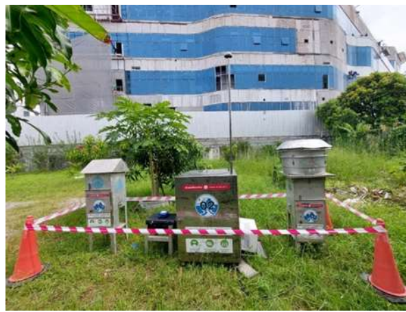
รูปที่ 2.1-27 การตรวจวัดปริมาณฝุ่นละอองรวม (TSP) และ PM10 บริเวณพื้นที่โครงการและบ้านเลขที่ 39 ช่วงเดือนกุมภาพันธ์ 2567
