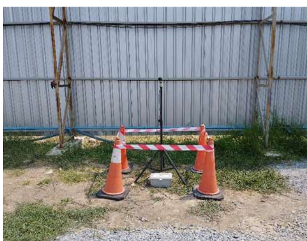
รูปที่ 2.1-35 การตรวจวัดระดับเสียง บริเวณพื้นที่โครงการและบ้านเลขที่ 39 ช่วงเดือนมีนาคม 2567
