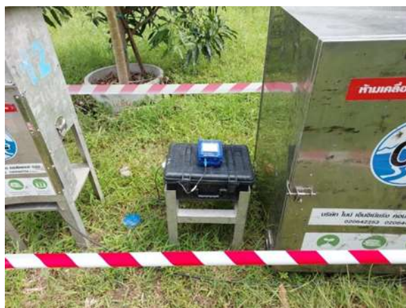
รูปที่ 2.1-31 การตรวจวัดความสั่นสะเทือน บริเวณพื้นที่โครงการและบ้านเลขที่ 39 ช่วงเดือนกุมภาพันธ์ 2567
