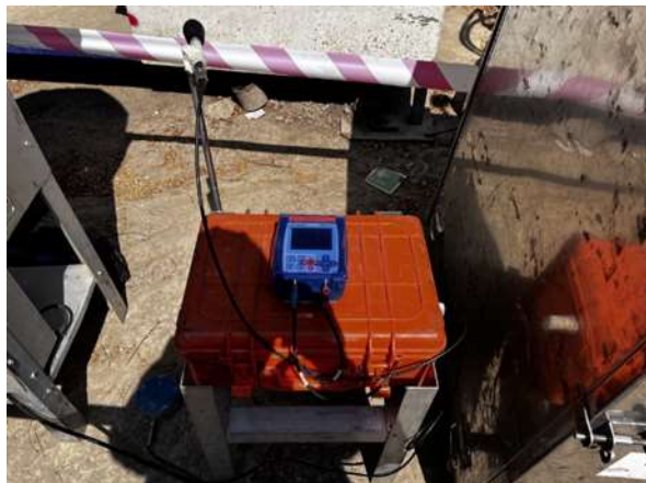
รูปที่ 2.1-30 การตรวจวัดความสั่นสะเทือน บริเวณพื้นที่โครงการและบ้านเลขที่ 39 ช่วงเดือนมกราคม 2567
