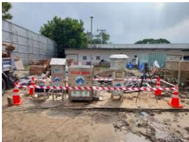
รูปที่ 2.1-27 การตรวจวัดปริมาณฝุ่นละอองรวม (TSP) และ PM10 บริเวณพื้นที่โครงการและบ้านเลขที่ 39 ช่วงเดือนกุมภาพันธ์ 2567
