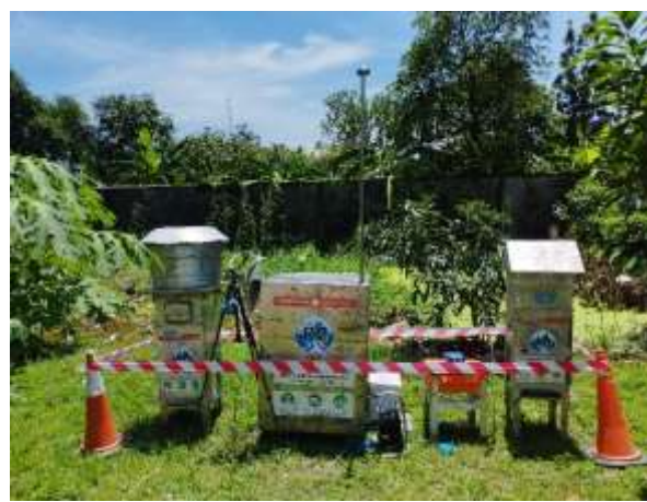
รูปที่ 2.1-34 การตรวจวัดปริมาณฝุ่นละอองรวม (TSP) และ PM-10 บริเวณพื้นที่โครงการและบ้านเลขที่ 39 ช่วงเดือนมีนาคม 2567
