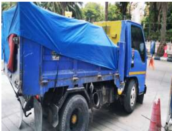
รูปที่ 2.1-2 การใช้ผ้าคลุมรถบรรทุกขนส่งวัสดุก่อสร้างและการทำความสะอาดล้อรถบรรทุกก่อนออกนอกโครงการ
