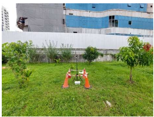
รูปที่ 2.1-29 การตรวจวัดระดับเสียง บริเวณพื้นที่โครงการและบ้านเลขที่ 39 ช่วงเดือนกุมภาพันธ์ 2567
