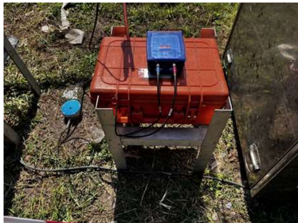
รูปที่ 2.1-30 การตรวจวัดความสั่นสะเทือน บริเวณพื้นที่โครงการและบ้านเลขที่ 39 ช่วงเดือนมกราคม 2567
